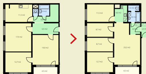
Obr. Ukázka rekonstrukce bytového jádra se změnou dispozičního řešení (efektivnější využití komunikací v bytě, změna na centrální dispozici)
